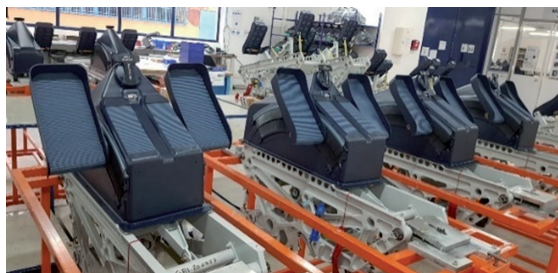
Palonnier, commandes de vol pour actionner la gouverne et le frein sol de l'avion.
